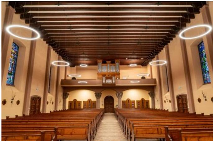
des soubassements- et plus particulièrement le remplacement de l'ancien éclairage très énergivore fonctionnant avec des ampoules au sodium par des appliques, spots et cerceaux LED.
